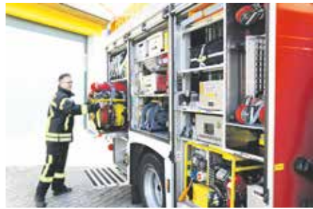
Das Hilfeleistungslöschgruppenfahrzeug (HLF 10) ist nicht nur für die Brandbekämpfung ausgestattet, sondern auch mit Gerätschaften, die das Befreien von Menschen aus einem Autowrack ermöglichen.
